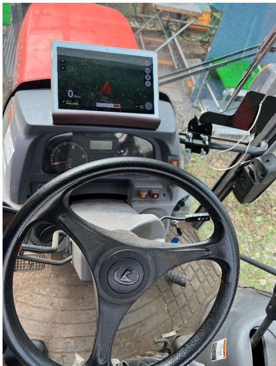
トラクターにタブレット (写真左) と受信機 (写真下) を設置し、画面を確認しながら作業をする。
